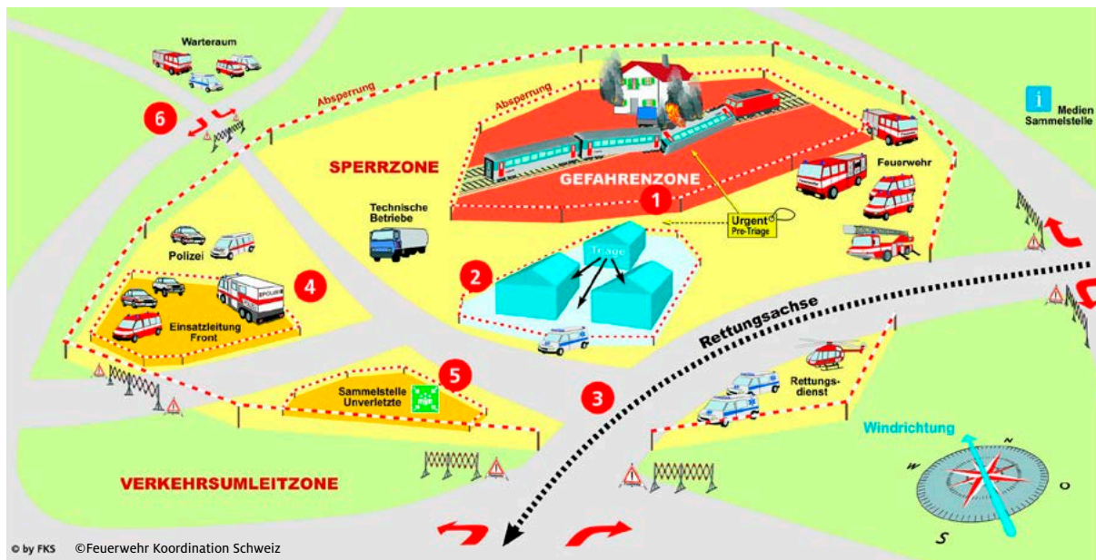
Abb. 15_2: Organisation des Schadenplatzes.
